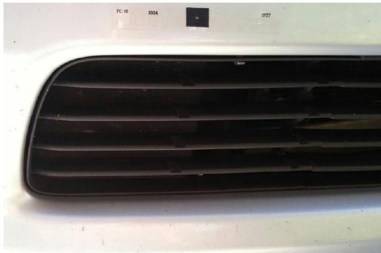
7. Une fois le transpondeur apposé sur le véhicule, permettre à l'adhésif de durcir durant un certain temps. En raison des écarts de température et d'humidité, le temps de durcissement complet peut varier. Dans la plupart des cas, l'adhésif durcira de 80 % en moins d'une heure, et complètement dans les 72 heures suivant l'application.
