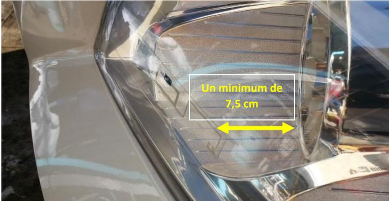
4. Apposer le transpondeur face à l'antenne et non sur une surface courbe.
