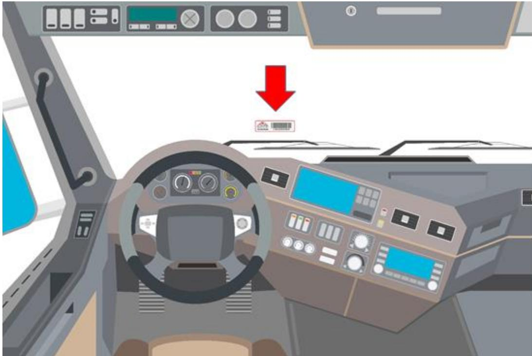
Apposer le transpondeur sur une surface dont la température se situe entre 21 °C et 38 °C (70 °F et 100 °F). Application non recommandée sur une surface dont la température est inférieure à 10 °C (50 °F).
